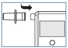
• Etape 1 : Insérez un embout buccal sur le capteur (attention : changer d'embout à chaque utilisation).
